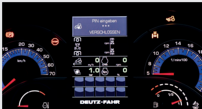
↑ Wyznacznik w swojej klasie: panel wskaźników InfoCenterPro: 5-calowy wyświetlacz ciekłokrystaliczny z informacjami na temat parametrów ciągnika. Blokada – immobiliser z możliwością uruchomienia ciągnika po wpisaniu kodu PIN.
