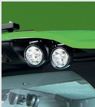
↑ Maksymalnie 16 reflektorów LED (generacja IV, 2500 lumenów/reflektor).
