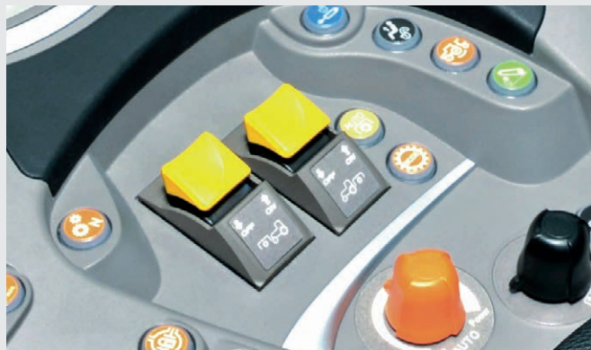
Przyciski do sterowania WOM pod ręką operatora w każdym wariancie kabiny.
