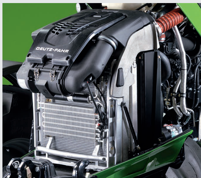
↑ Technologia PowerCore: 20% większa przepustowość filtra powietrza.
