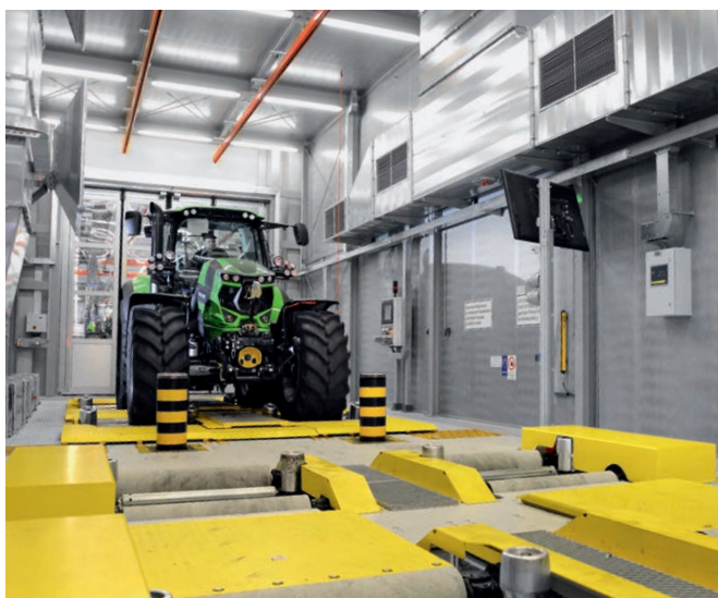
↑ Unikalne testy dynamiczne oceny osi oraz testy dynamometryczne.
