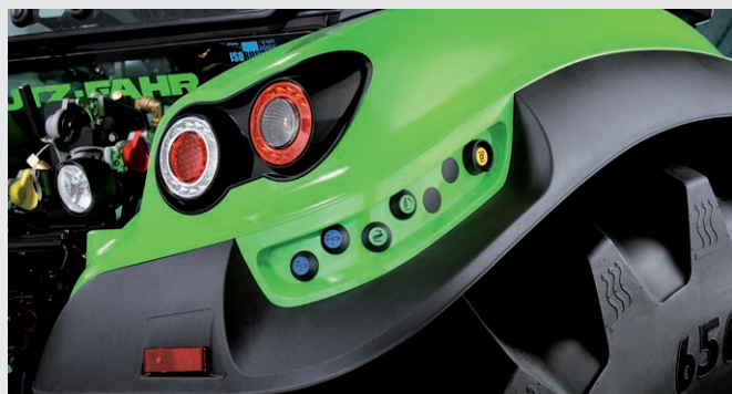
↑ Prosta obsługa układu hydraulicznego, podnośnika i WOM na błotnikach kabiny.
