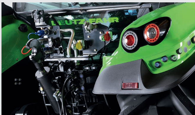
↑ Skuteczny i bezpieczny układ pneumatycznych hamulców przyczep.
