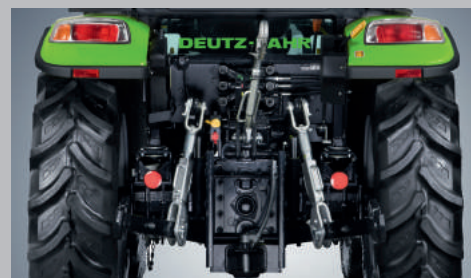
Hydraulika z wydajną pompą 50 l/min, maksymalnie 3 obwoły, podnośnik tylny 3500 kg, trzy prędkości WOM.
