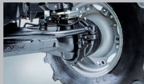
Napęd na cztery koła i blokada mech. sterowane przyciskami. Duży kąt skrętu kół 55 stopni. Hamulce na cztery koła.
