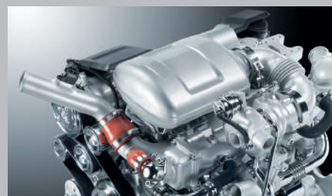
Silnik FARMotion z układem wtryskowym Common Rail 2000 bar, układem oczyszczania spalin z EGR i DOC.
