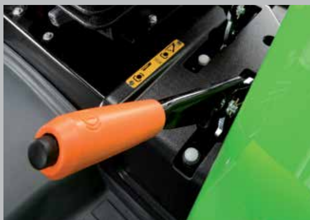
Dźwignia hamulca postojowego obok fotela operatora.
