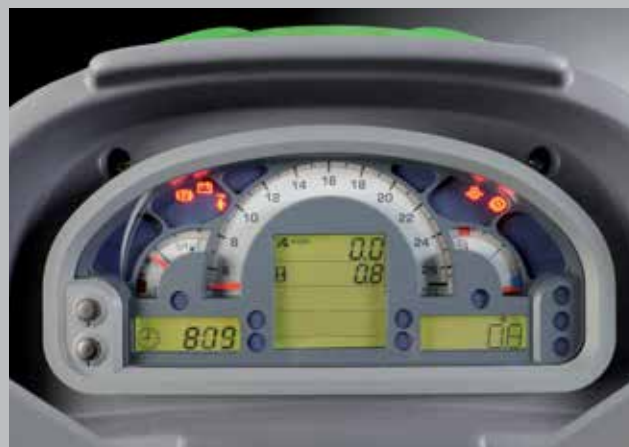
Nowy panel na desce rozdzielczej z wyświetlaczem elektronicznym - wszystkie informacje na temat parametrów pracy ciągnika.
