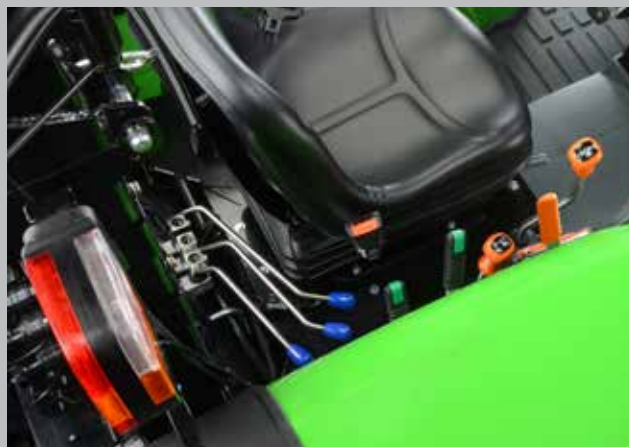
Maksymalnie 3 sterowane mechanicznie obwody hydrauliki.
