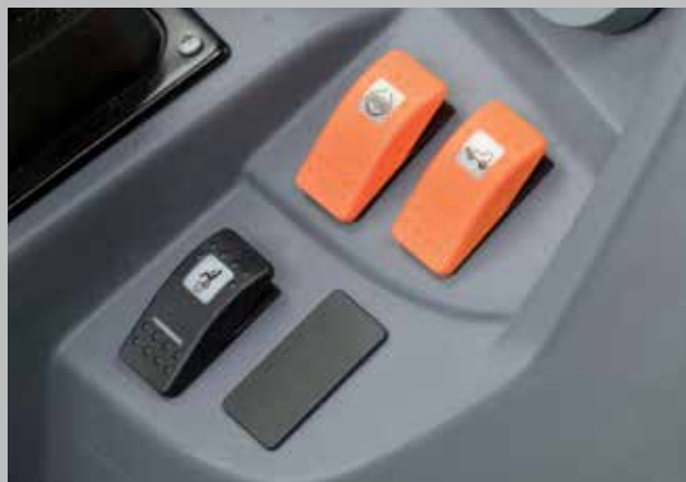
Napęd na cztery koła i blokada mechanizmów różnicowych mogą być uruchamiane przyciskami na desce rozdzielczej.
