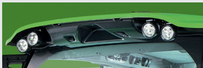
↑ Rozbudowany pakiet reflektorów LED z lampami o mocy 2500 lm każdy.
