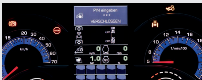
↑ Zestaw wskaźników i panel InfoCenterPro. Informacje o wszystkich parametrach użytkowych ciągnika. Blokada – immobiliser z kodem PIN.
