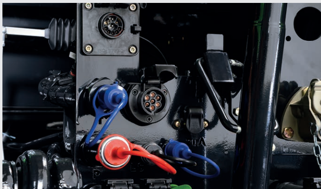
↑ Gniazda ISOBUS montowane z przodu i z tyłu ciągnika pozwalają obsługiwać maszyny różnych producentów.
