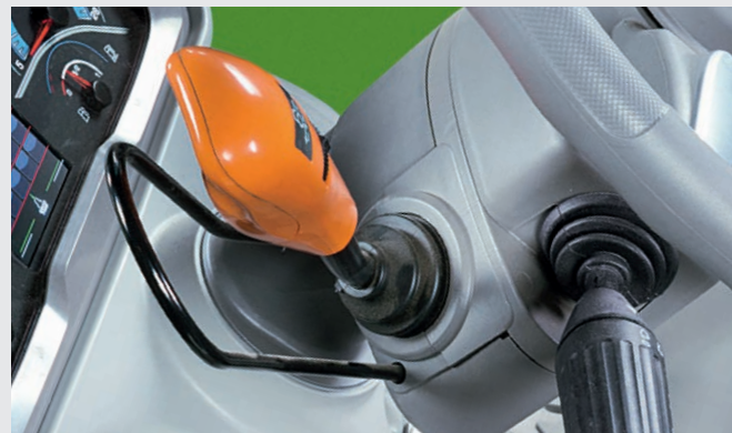
↑ Rewers PowerShuttle i sprzęgła SensClutch – możliwość regulacji szybkości działania rewersu.
