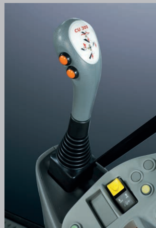
Joystick sterowania ładowaczem z przyciskami pól biegów Powershift. Funkcja Stop&Go, układ kierowniczy SDD...
