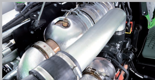
... katalizator DOC (Diesel Oxidation Catalyst) dla redukcji zanieczyszczeń w spalinach.
