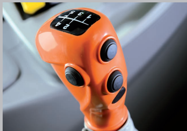
Zmiana biegów z wciśniętym przyciskiem sprzęgła.
