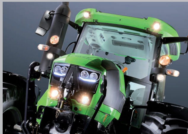
Rozbudowany pakiet reflektorów. Pełna widoczność dookoła ciągnika także w nocy. W masce silnika zamontowano światłą LED do jazdy dziennej.
