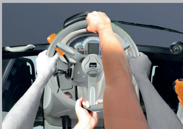
Układ kierowniczy SDD redukujący o połowę liczbę obrotów kołem kierownicy.
