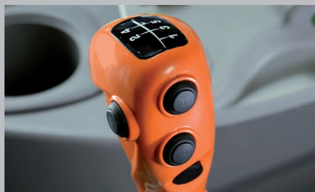
Przyciski sprzęgła Comfort Clutch i półbiegów Powershift. Prosta i komfortowa obsługa w trakcie jazdy.
