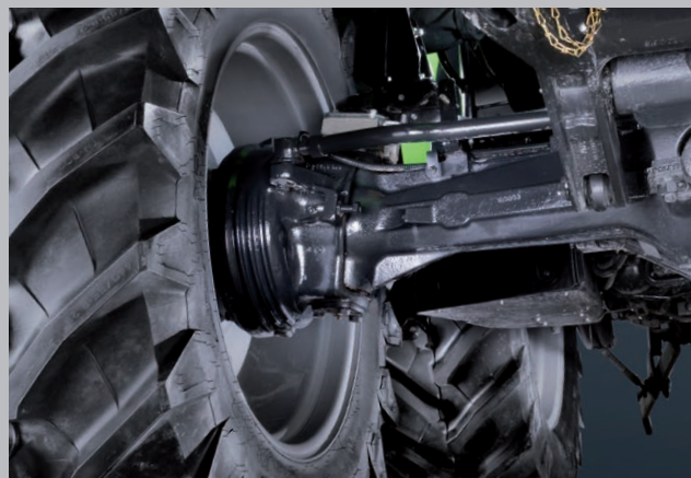
Pełne bezpieczeństwo według DEUTZ-FAHR. Układ hamulcowy z tarczami w kąpiel olejowej na 4 kołach.
