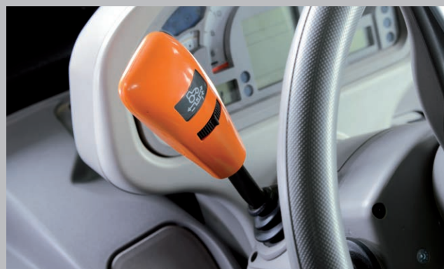
Rewers Powershuttle to wyposażenie standardowe. Pokrętło na dźwigni do regulacji szybkości działania rewersu.
