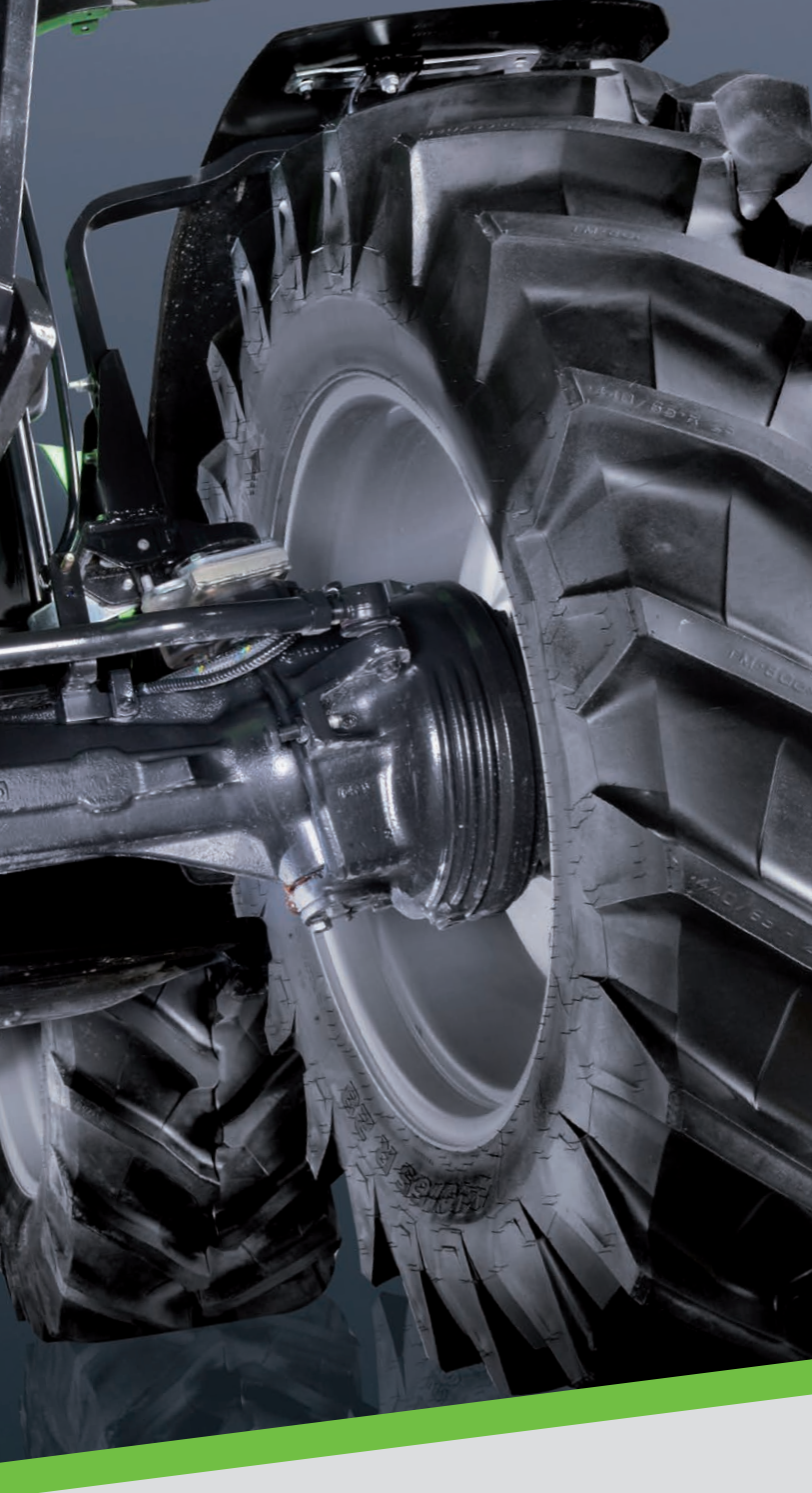
Pełne bezpieczeństwo według DEUTZ-FAHR. Układ hamulcowy z tarczami w kąpiel olejowej na 4 kołach.
