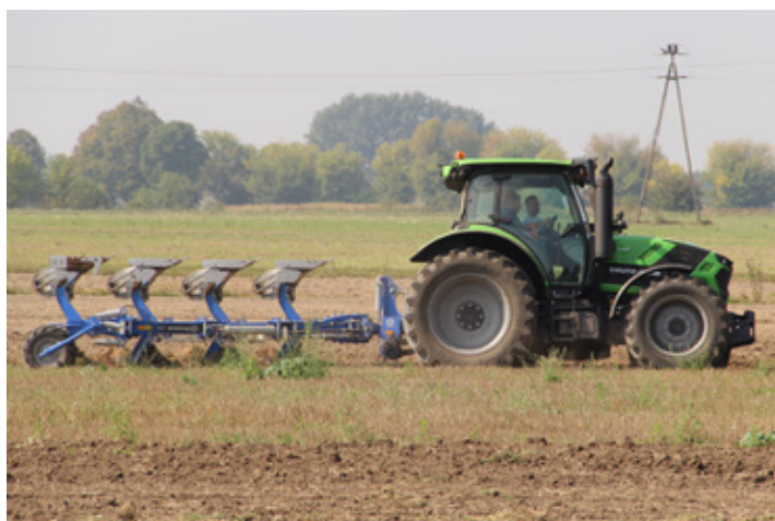
Ciągnik Deutz-Fahr 6130 w trakcie orki czterokibowym pługiem obracalnym Overum CX2
